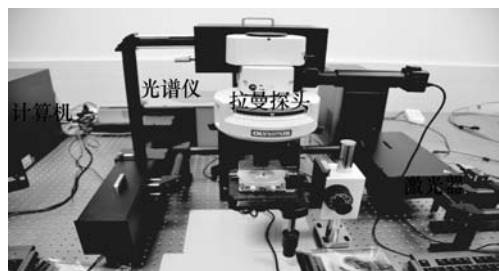
图 1 变压器油中溶解故障气体拉曼检测平台实物图
